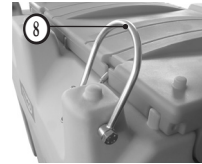
Occhiello per gru (ripiegato in alto)
